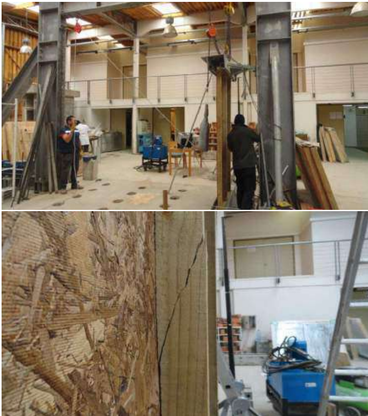
Figura 2.26: Modo de falla característico en ensayo de impacto en cara con placa arriostrante de muros con estructura de madera de pie derechos de 45x69 mm.
