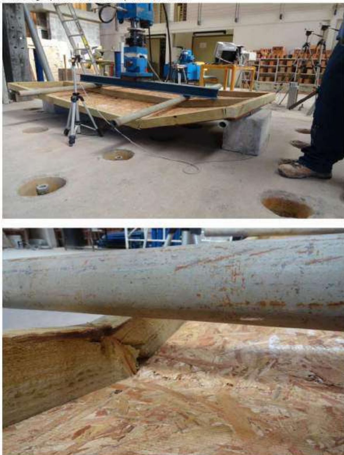
Figura 2.24: Modo de falla característico de ensayo de flexión en muros con estructura de madera con la carga aplicada en la cara sin placa arriostrante.
